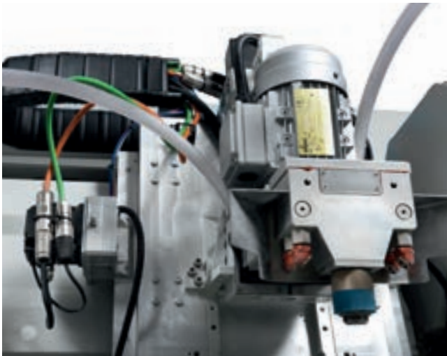
Accès aisé pour changer les meules, via le renversement de la broche.
